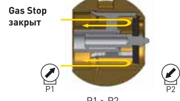
Термозапорный клапан автономен и энергонезависим, он не требует периодического технического обслуживания и не нуждается в поверке.
