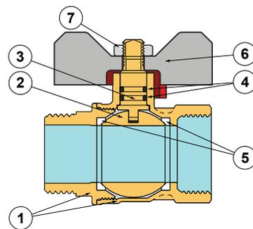
В соответствии с требованиями норм безопасности шпindelь (3) вставляется изнутри корпуса (корпус состоит из двух корпусных деталей (1), имеющих резьбовое соединение с фиксатором резьбы LOXEAL), что делает невозможным вылет шпинделя из корпуса даже в случае деструктивных действий (попытки разборки) в процессе эксплуатации шарового крана, находящегося под давлением.
