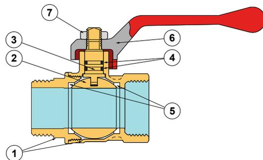
В соответствии с требованиями норм безопасности шпindelь (3) вставляется изнутри корпуса (корпус состоит из двух корпусных деталей (1), имеющих резьбовое соединение с фиксатором резьбы LOXEAL), что делает невозможным вылет шпинделя из корпуса даже в случае деструктивных действий (попытки разборки) в процессе эксплуатации шарового крана, находящегося под давлением.
