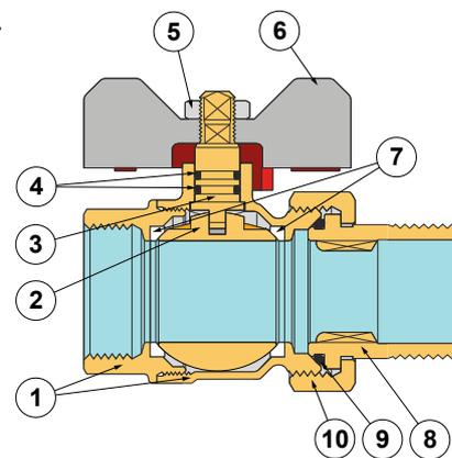
В соответствии с требованиями норм безопасности шпindelь (3) вставляется изнутри корпуса (корпус состоит из двух корпусных деталей (1), имеющих резьбовое соединение с фиксатором резьбы LOXEAL), что делает невозможным вылет шпинделя из корпуса даже в случае деструктивных действий (попытки разборки) в процессе эксплуатации шарового крана, находящегося под давлением.
